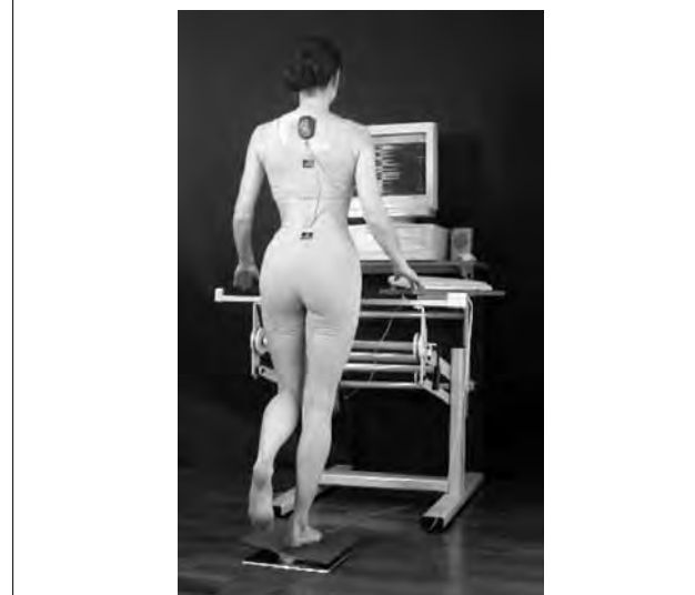
Fig. 2. Strumento per quantificare il livello di stabilità funzionale degli arti inferiori e del sistema colonna-bacino dell'atleta, con lettore posturale in regione sternale.
